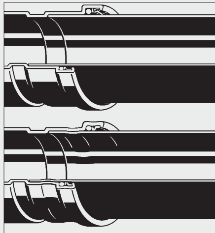
Bild 2/1: XL-Pressverbinder im unverpressten und verpressten Zustand
