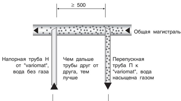
Во избежание попадания шлама в "variomat" расширительные трубы должны подходить к магистрали сверху или, как изображено, снизу с подключением при помощи плунжерного соединения.
