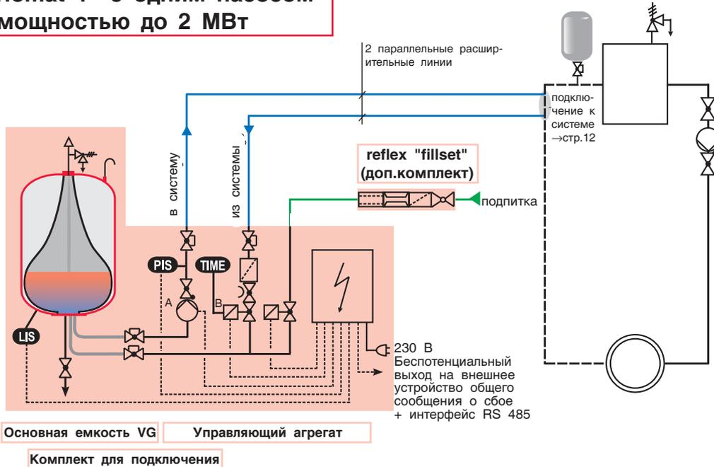
**reflex "variomat 2-1" с одним насосом системы мощностью до 4 МВт**
