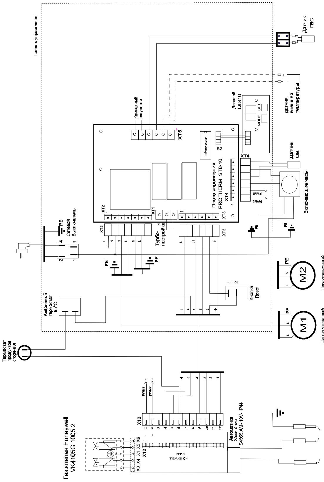
**Рис. 7** Схема электрического подключения котла PROTHERM 20 (30, 40) KLZ
