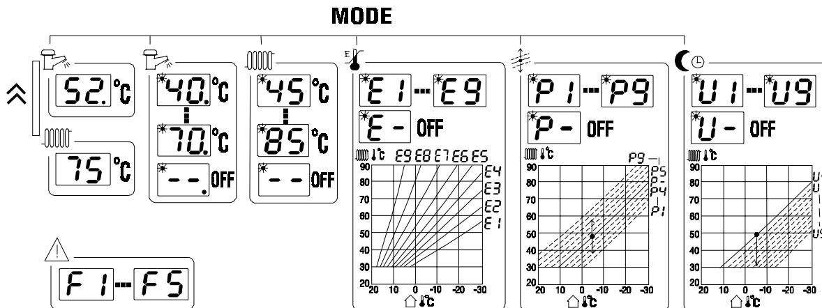
**Рис. 4 Схема кнопочного управления**
