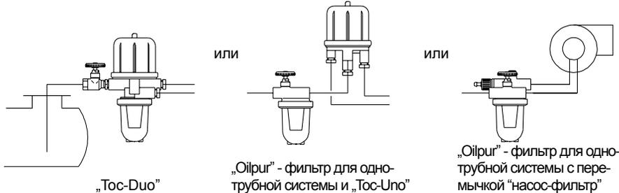
Только подающий топливопровод к емкости, расход топлива соответствует мощности форсунки (отопительная нагрузка в кВт - 10 соответствует мощности форсунки в л/ч). Насос горелки с подключением подающего и обратного топливопроводов. Для бесперебойной работы горелки рекомендуется применять автоматическое удаление воздуха через „Toc-Duo” или „Toc-Uno”.
