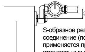
S-образное резьбовое соединение (полезная модель) применяется при замене отопительных приборов на новые, с иным межосевым расстоянием.
