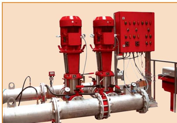
**Описание конструкции:** В комплект установки Hydro MX входят два вертикальных многоступенчатых насоса типа CR (рабочий и резервный), всасывающий и нагнетательный коллекторы, шкаф управления и запорно-регулирующая арматура, устройства контроля и автоматики. Все оборудование смонтировано на единой раме (по заказу шкаф управления может размещаться отдельно). Шкаф управления и насосы окрашены в красный цвет.
