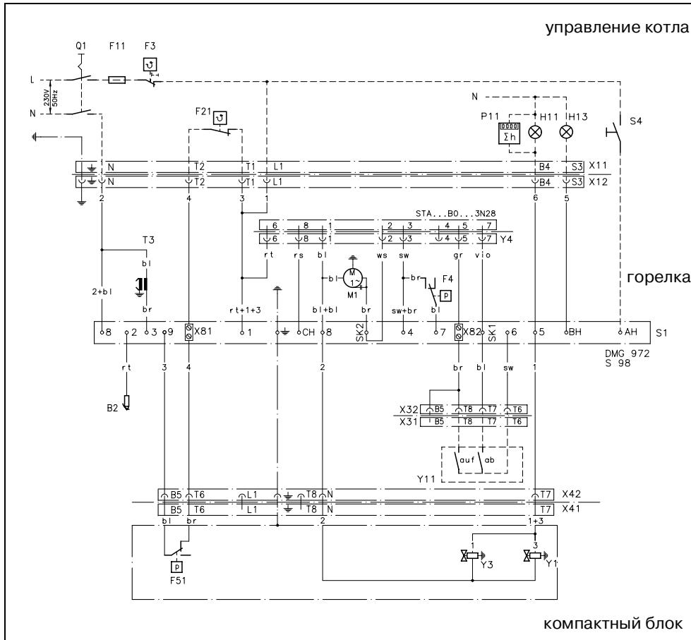
Схема электрических соединений RG30
