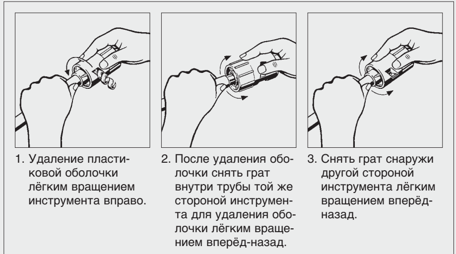
Рис. 3/8: Последовательность удаления оболочки и снятия грата с труб 'profipress THERM'
