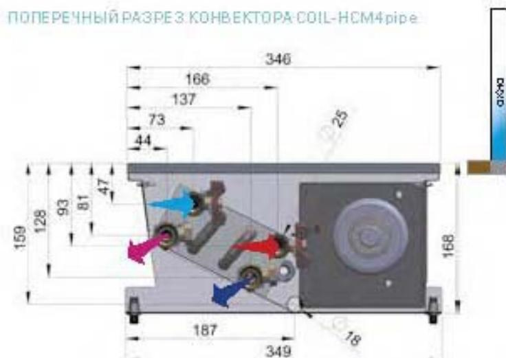
ПРОДОЛЬНЫЙ РАЗРЕЗ КОНВЕКТОРА COIL-HCM4pipe
