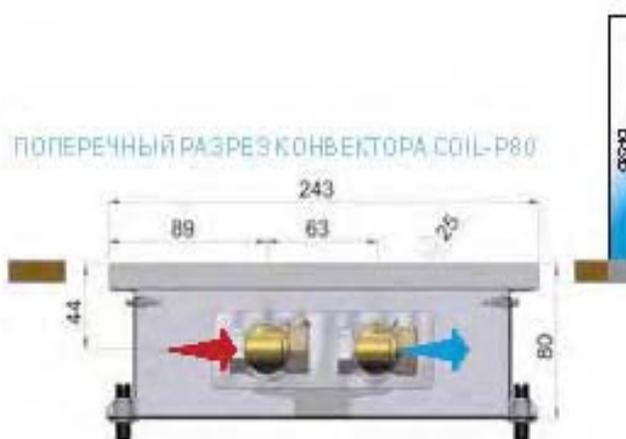
ПОПЕРЕЧНЫЙ РАЗРЕЗ КОНВЕКТОРА COIL-P80
