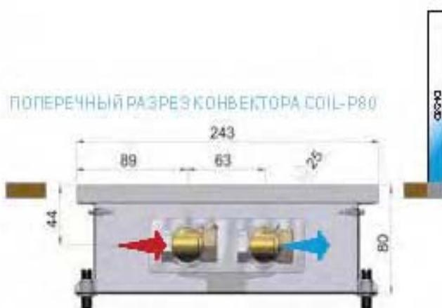
ПОПЕРЕЧНЫЙ РАЗРЕЗ КОНВЕКТОРА COIL-P80
