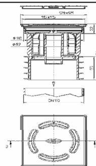
Трап HL73Pr предназначен для монтажа в сложных случаях при новом строительстве, либо при реконструкции помещений (демонтаже и замене старых трапов).
